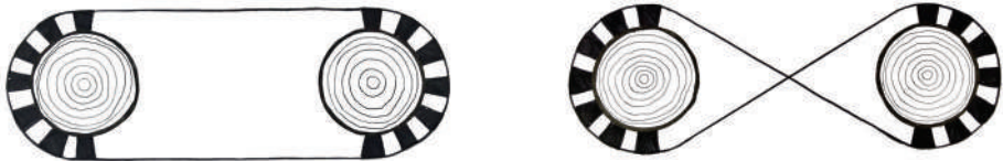
Figura 16: Formas recomendadas de instalar el sistema de cable y listones
